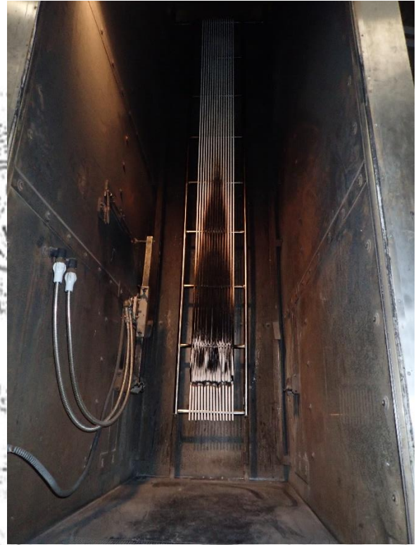
Messung der Wärmefreisetzung und Raucherzeugung von Kabeln nach EN 50399 – nach dem Versuch (Quelle: VDE Prüf- und Zertifizierungsinstitut GmbH)
