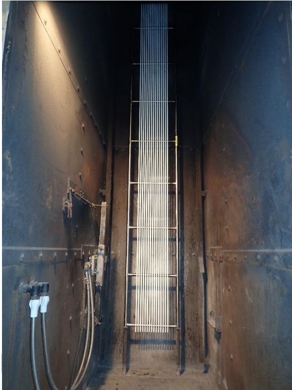
Messung der Wärmefreisetzung und Raucherzeugung von Kabeln nach EN 50399 – vor dem Versuch (Quelle: VDE Prüf- und Zertifizierungsinstitut GmbH)
